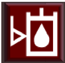
Figura 89: Bajo nivel de aceite hidráulico
