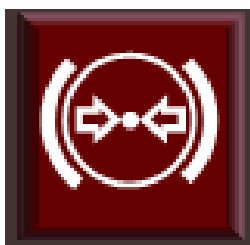
Figura 88: Baja presión en sistema de frenos servicio
